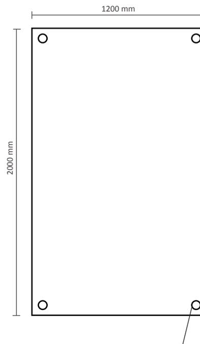
4 Metallösen ( $\varnothing 12\text{mm}$  Innendiameter)
