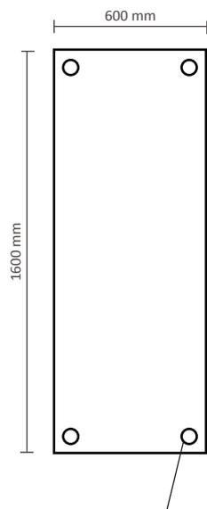
4 Metallösen ( $\varnothing 12\text{mm}$  Innendiameter)
