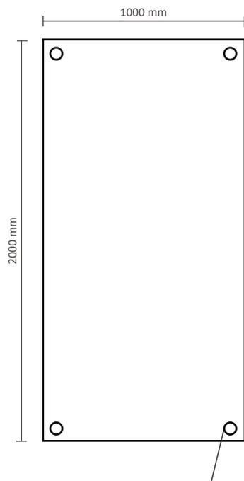
4 Metallösen ( $\varnothing 12\text{mm}$  Innendiameter)
