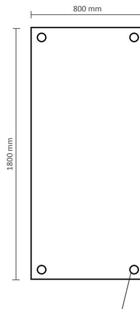
4 Metallösen ( $\varnothing 12\text{mm}$  Innendiameter)
